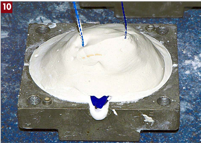
10 Des événements sont réalisés au bout des crochets pour faciliter la circulation.
