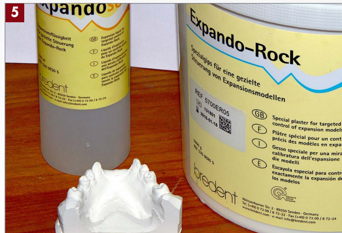
5 Plâtre spécial conçu pour résister jusqu'à 380°C, le dosage avec le liquide spécial se fait en fonction du matériau.
